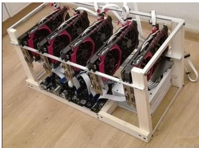
Ферма для майнинга Ethereum(ETH), мощностью в 110 Mh/s
